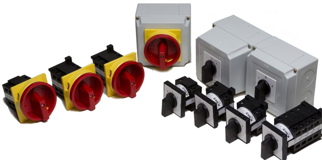
Переключатели представляют собой наборную конструкцию, собранную на квадратном стержне идентичных по конструкции коммутирующих пакетов (от 1 шт. до 12 шт.), фиксирующего пакета (или самовозврата), передней панели, основания и ручки, стянутых шпильками и гайками. Стержень от продольных смещений удерживается упорной шайбой. Поворот ручки переключателя приводит во вращение стержень, а вместе с ним и кулачки коммутирующих пакетов, обеспечивающих размыкание или замыкание контактов.
